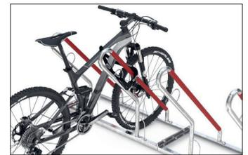
Der Anlehnparkter 0500 XBF zur Bodenmontage im Freien besteht aus einer robusten Stahlkonstruktion aus Rundrohr, ist korrosionsgeschützt und wertbeständig durch Verzinkung. Dank seiner funktionellen Anlehnbügel und einem kunststoffummantelten Anschlagsschutz in signalrot bietet er einen perfekten Schutz für hochwertige Fahrräder vor Umfallen oder mutwilligem Umdrücken. Der Radabstand beträgt 500 mm, zweiseitig 540 mm. Der
