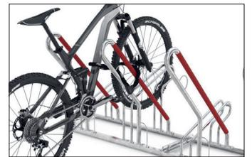
Auffälliges Detail an diesem Fahrradparksystem sind die mit signalrotem Kunststoff ummantelten schrägen Anlehnbügel. Sie schützen jedes Fahrrad oder E-Bike gegen mutwilliges oder versehentliches Umdrücken und Folgeschäden an den Felgen. Integrierte Stahl-Rundösen sorgen für optimierten Diebstahlschutz. Der Bügelabstand ist großzügig bemessen und eignet sich für Fahrräder mit Reifenbreiten bis 55 mm. Der Radabstand beträgt 500 mm, zweiseitig 540 mm. Als Aufsteller bieten Sie
