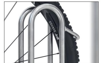
Der Standparker 4000 BR bietet auch Fahrrädern mit einer Reifenbreite bis zu 64 mm oder 29- Zoll Rädern genügend Platz. Die extrem hohen Einstellbügel verhindern wie schon beim Modell 4000 ein Umknicken der Fahrräder und die damit verbundenen Beschädigungen der Felgen. Gleichzeitig bieten sie eine Anschlussmöglichkeit für Schlösser. Geparkt wird höhenversetzt oder auf Wunsch auch zweiseitig, um wertvollen Platz zu sparen.
